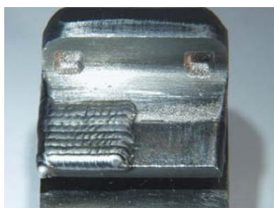
Acciaio 1.2764, Applicazione superficiale a più strati
