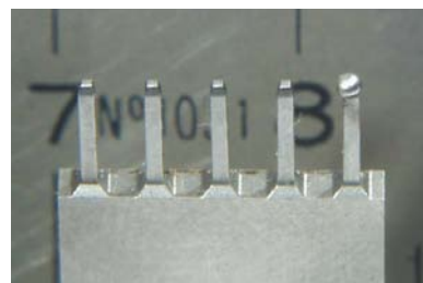
Acciaio 1.2767, Saldatura a punti
