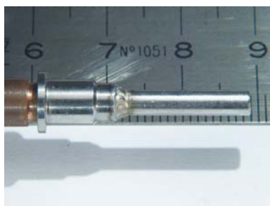
Acciaio 1.4021, Tubo + Flangia saldatura a tenuta di gas
