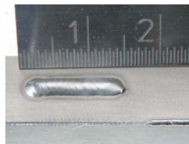
Acciaio 1.2764, Spigolo sottile, grande superficie
