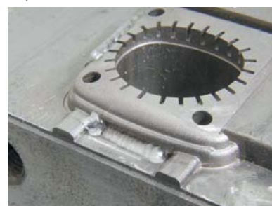
Acciaio 1.2343, Applicazione + Saldatura ad angolo
