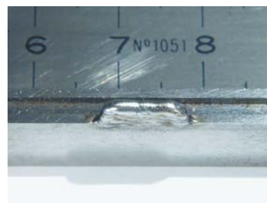
Acciaio 1.2367, Saldatura strutturale
