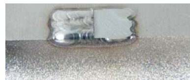
Acciaio 1.2367, superficie non porosa e bordo di tenuta
